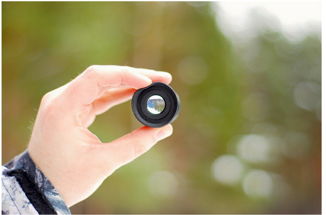
Окуляр 10mm с данным телескопом позволяет достичь увеличения в 90 крат.
