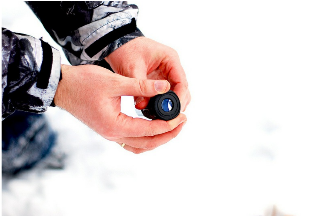
Окуляр 25mm с данным телескопом дает увеличение в 36 крат.
