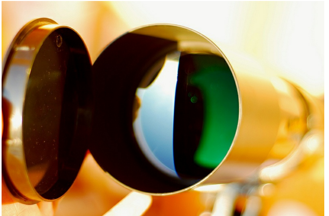
Главная линза, с нанесенным просветляющим покрытием.
